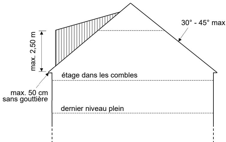
Les découpes dans les toitures, telle qu'une loggia, d'une surface égale ou inférieure à 6 m<sup>2</sup>, mesurée horizontalement et en retrait par rapport au nu de la façade sont admises.
