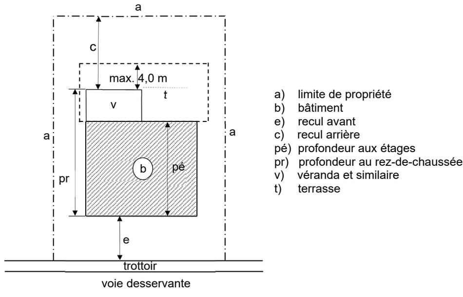
Pour les constructions formées par deux ou plusieurs corps de bâtiment, la profondeur des constructions, définie conformément à l'alinéa premier, est mesurée entre façades avant et arrières de chaque corps de bâtiment, un tel décalage ne peut dépasser 2,50 mètres. Lorsque les façades frontales d'une construction ne sont pas parallèles, la profondeur la plus grande est déterminante.
