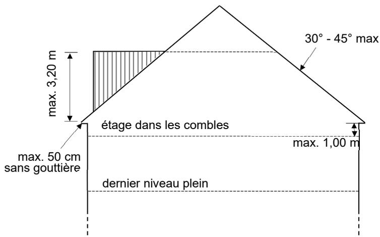
La hauteur corniche peut être à 1,00 mètre maximum au-dessus du niveau de la dalle supérieure du dernier niveau plein autorisé.
