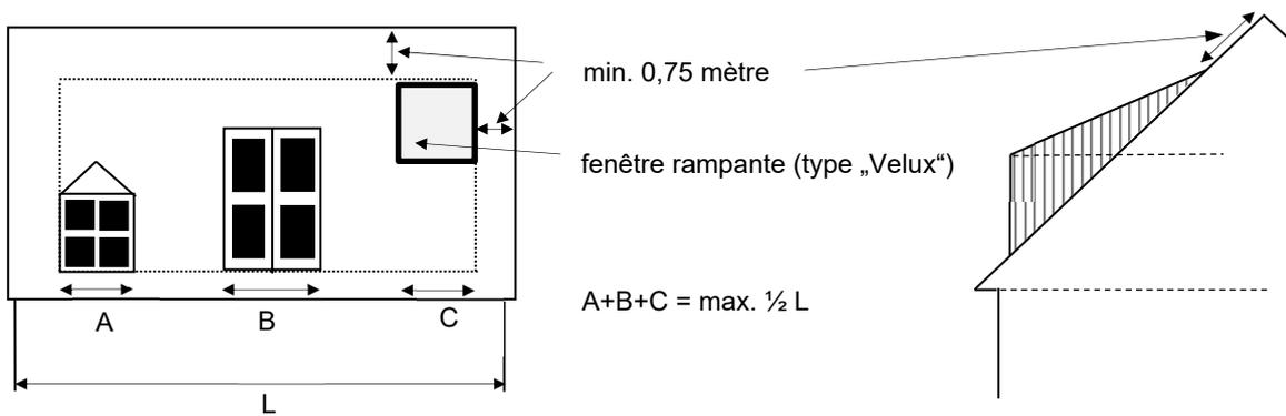
Ces éléments doivent respecter une hauteur maximale de 2,50 mètres à partir du niveau de la corniche.
