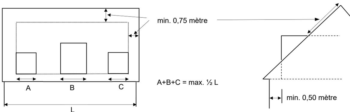
Ces éléments doivent respecter une hauteur maximale de 3,20 mètres à partir du niveau de la corniche.
