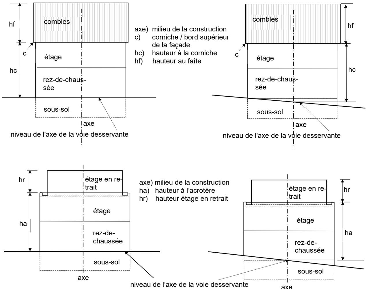
b) Pour les constructions agricoles, artisanales ou similaires non adjacentes à la voie desservante, la hauteur est définie comme la différence moyenne entre le niveau du terrain naturel et le niveau de la corniche et du faîte, mesurée dans l'axe de la façade frontale.
